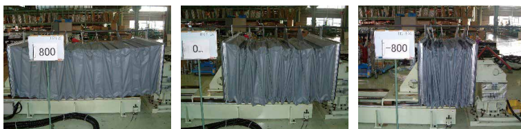
角型水平タイプ一般空調ダクト試験風景（軸方向への変位）
