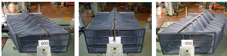
角型水平タイプ一般空調ダクト試験風景（軸直角方向への変位）
