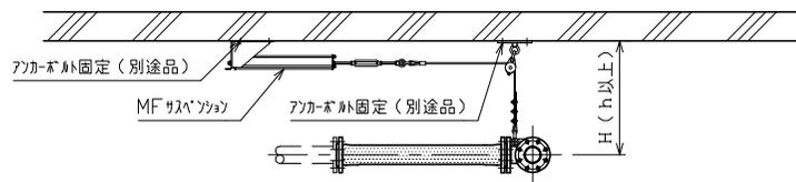
※MF サスペンション (滑車吊りタイプ) 天井取付詳細
